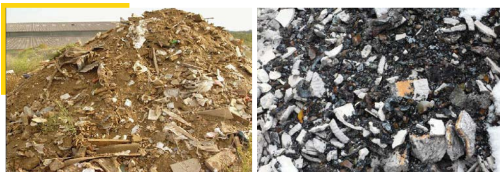
Abbildung 174: Ofenausbruch aus Gießerei – nicht gelisteter Abfall
