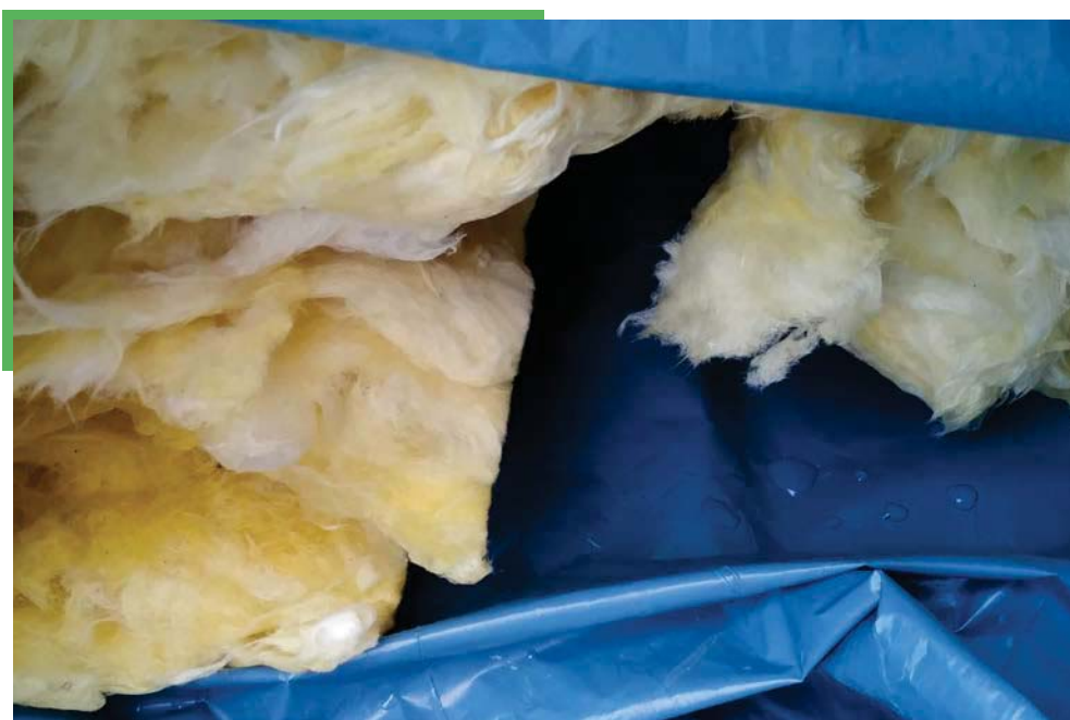
Abbildung 138: Glaswollabfälle aus heutiger Produktion (biolöslich) zur Verwertung
