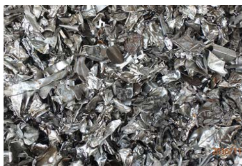
Abbildung 71: Nirosta-VA Edelstahlabfälle > 90 % Metallanteil
