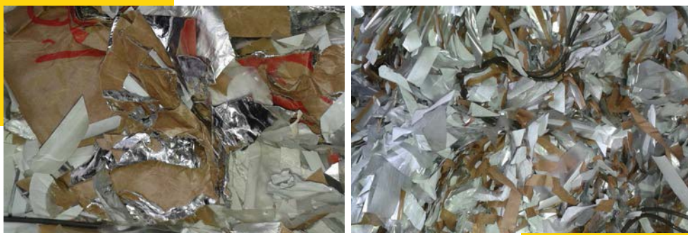
Abbildung 12: Gemisch diverser Verbundmaterialabfälle - nicht gelisteter Abfall
