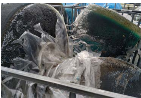
Abbildung 179: Kunststoffabfallgemisch aus PP, PS mit 16-20% an Störstoffen inklusive PVC - Y48 (EU48)
