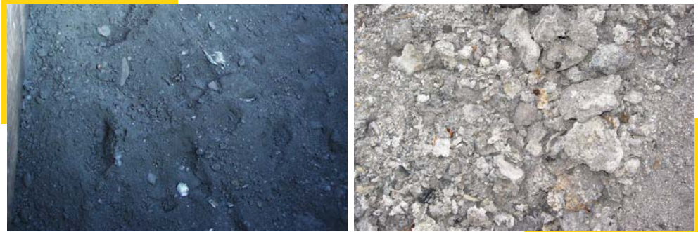
Abbildung 20: Aluminiumkrätze (Gefahrenkriterium H4.3) – nicht gelisteter Abfall
