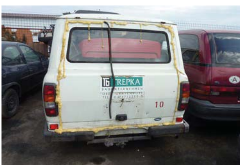
Abbildung 117: Autowrack, nicht schadstoffentfrachtet – nicht gelisteter Abfall
