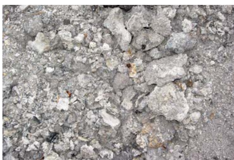
Abbildung 29: Aluminiumkrätze (Basler Kriterium H4.3) – nicht gelisteter Abfall
