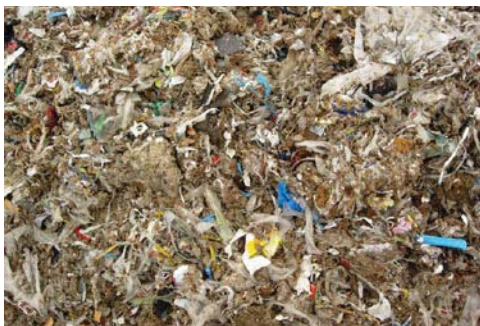
Abbildung 197: Kunststoffe von Monitorrückwänden mit weit mehr als 0,2 % Bromgehalt, wobei die POP-Grenzwerte überschritten wurden – Y48 (bzw. EU48)
