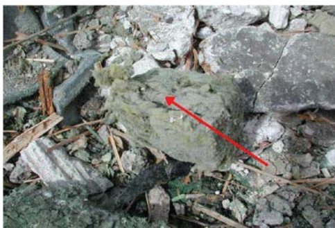
Abbildung 48: Gemischter Bauschutt – nicht gelisteter Abfall
