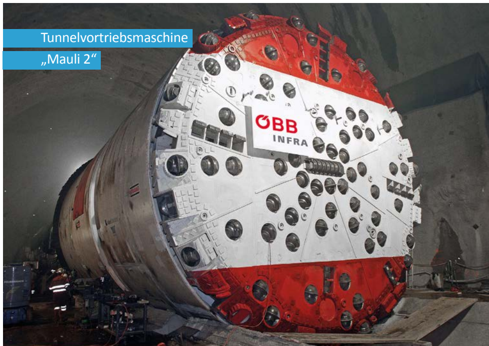
Abbildung: Beim Rohbau-Baulos KAT 2 eingesetzte Doppelschild-Tunnelvortriebsmaschine
