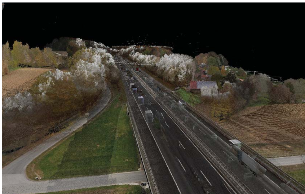
Abbildung 4: Simulationsfähiger digitaler Zwilling der Autobahn für die hydrologische Simulation der Aquaplaning-Gefahr auf Basis von Wetterprognosen © JOANNEUM RESEARCH
