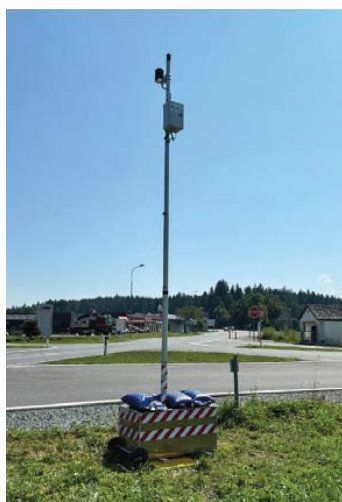
Abbildung 2: Das mobile System im Einsatz, um Verkehrsmengen, Geschwindigkeiten und Konfliktsituationen in der Umgebung zu analysieren, und Visualisierung der gesammelten Daten als dreidimensionales Livebild © ALP.Lab
