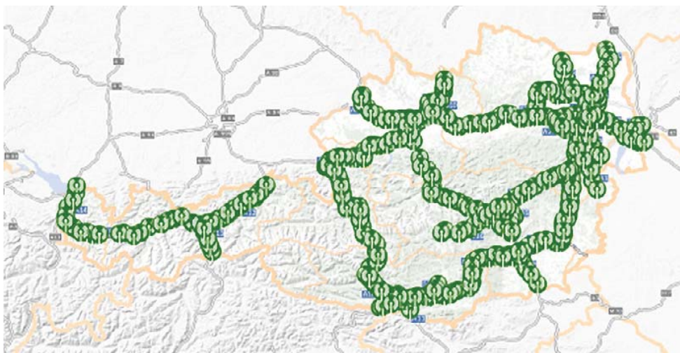
Abbildung 14: Stand des Ausbaus mit C-ITS-Straßeneinheiten auf Autobahnen und Schnellstraßen Ende 2025 © ASFINAG
