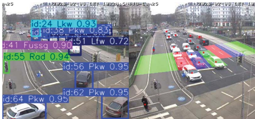
Abbildung 18: Zwei Entwickler:innenansichten einer Verkehrskamera. Links mit erkannten Verkehrsteilnehmenden, rechts mit farblich markierten Zählflächen © ITS Vienna Region
