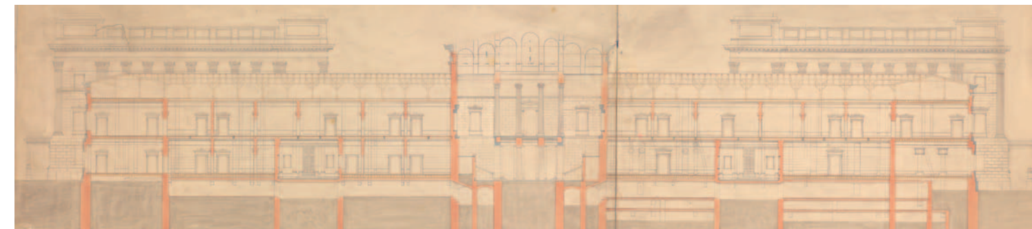
Schnitt durch den Vordertrakt (Minister- und Kanzleiräume), Haupttreppe und Vestibül © Parlamentsdirektion
